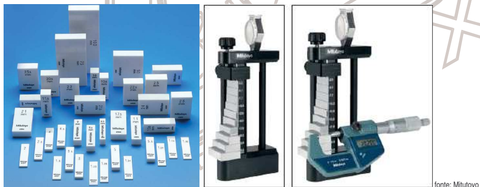
Figura 18 – Exemplo de blocos padrão e sua utilização para realizar a calibração de micrómetro
