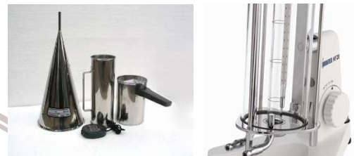
Figura 13– Viscosímetros: por escoamento e por queda de esfera
