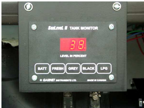
Figura 15 – Indicador de enchimento de um tanque
